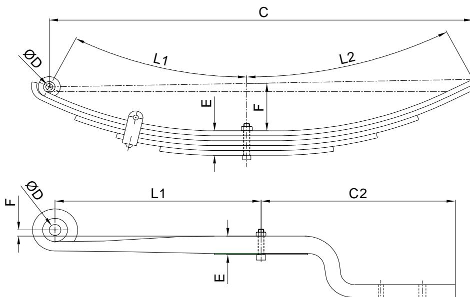
$L_1$  i  $L_2$  = Długości mierzone od środka ucha resoru (lub krańca pióra) do rowka w piórze resoru wzdłuż wygięcia pióra.
